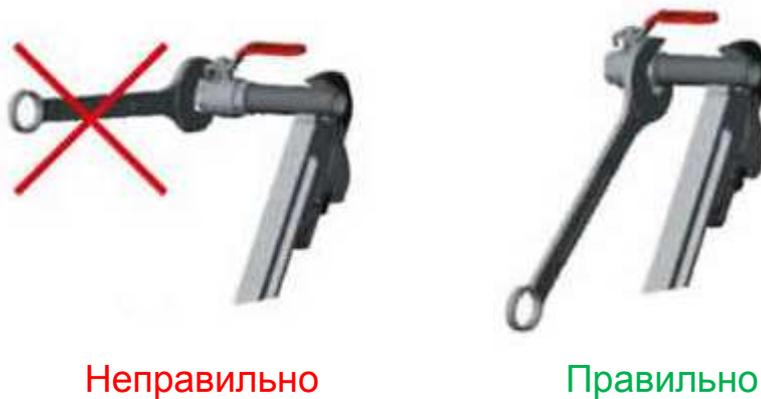
При монтаже разрешается использовать инструмент соответствующий размерам трубы и крана. Запрещается удлинять ключи или использовать дополнительные рычаги. Кран и трубопровод при монтаже должны быть соосны. Устанавливать кран с принудительным натягиванием его на трубу или подтягивать трубу к крану запрещено.
